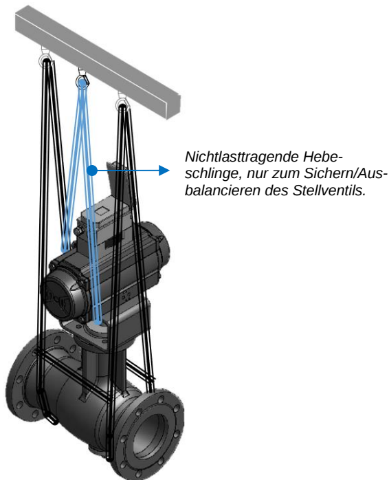
Bild 5.1: Hebepunkte - DKV Baureihe 72/AT, 73/AT, 82/AT
