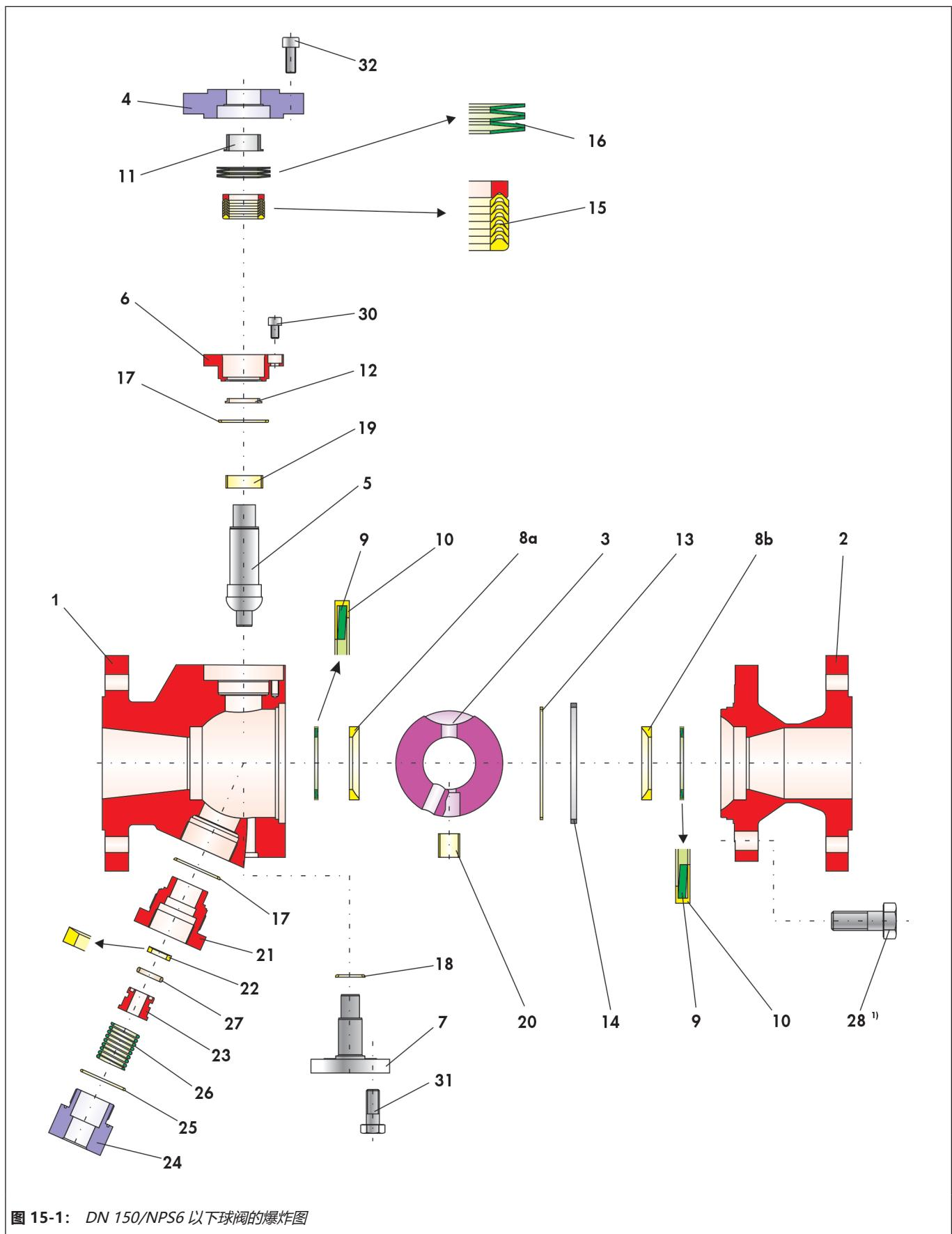
图 15-1: DN 150/NPS6 以下球阀的爆炸图
