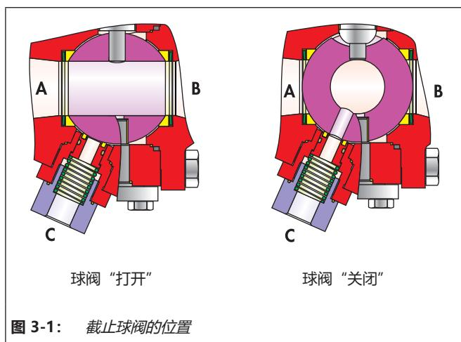
当阀球处于此关闭位置时，排出端口通过阀球的泄漏孔连接至两个座环之间的腔穴。
