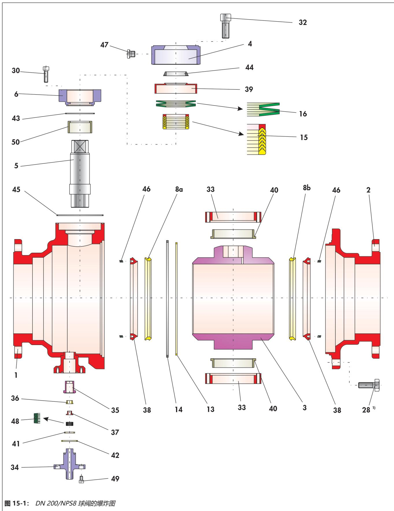
图 15-1: DN 200/NPS8 球阀的爆炸图
