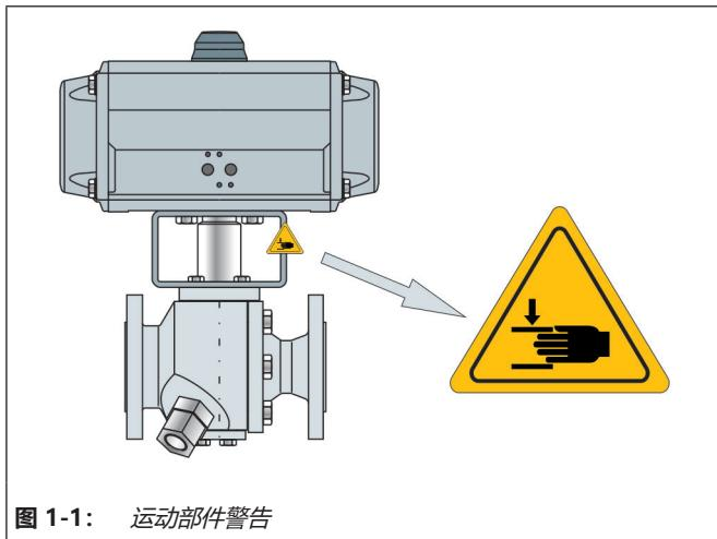
只要已将气源连接至执行机构，当执行机构和切换轴进入阀轭时，其旋转运动就可能引起夹伤危险。经操作员请求，阀门上可能贴附警告说明。
