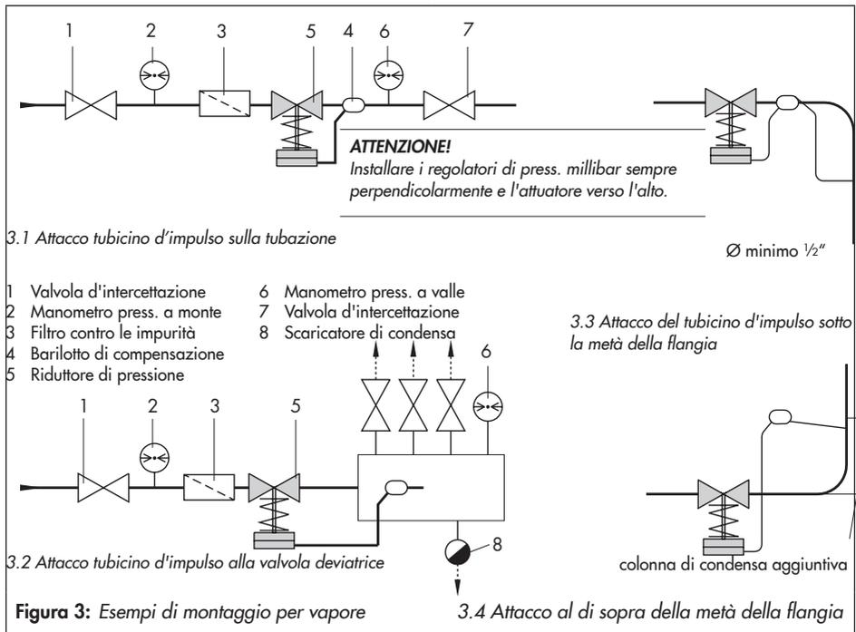
La posizione di montaggio del barilotto di compensazione viene indicata da un'etichetta, una freccia e la parola „sopra“ incisa sulla parte superiore del barilotto.
