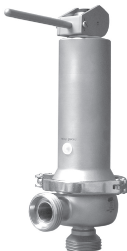
Vanne de décharge type 2371-01 Réglage manuel de la consigne, avec blocage de course manuel
