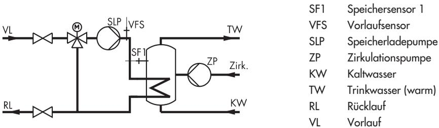
Bild 6 · Trinkwassererwärmung im Speichersystem, gültig für die Anlagen 4, 5, 7, 8, 9 und 10
