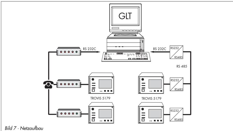
Bild 7 · Netzaufbau
