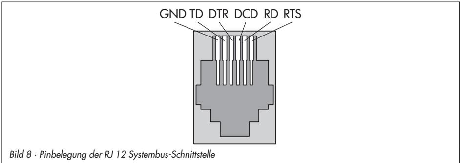
Bild 8 - Pinbelegung der RJ 12 Systembus-Schnittstelle
