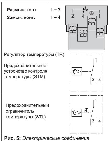
Рис. 5: Электрические соединения
