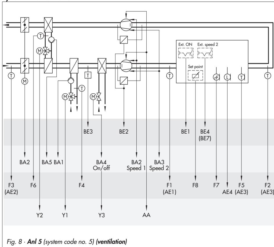
Fig. 8 · Anl 5 (system code no. 5) (ventilation)
