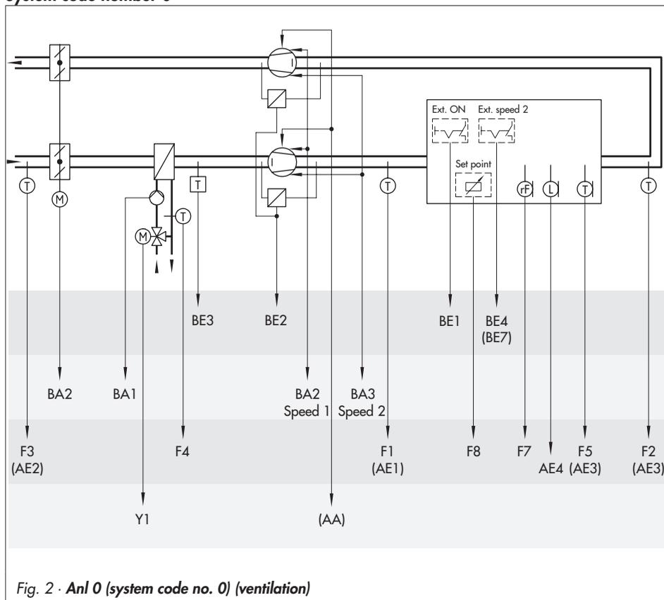
Fig. 2 · Anl 0 (system code no. 0) (ventilation)
