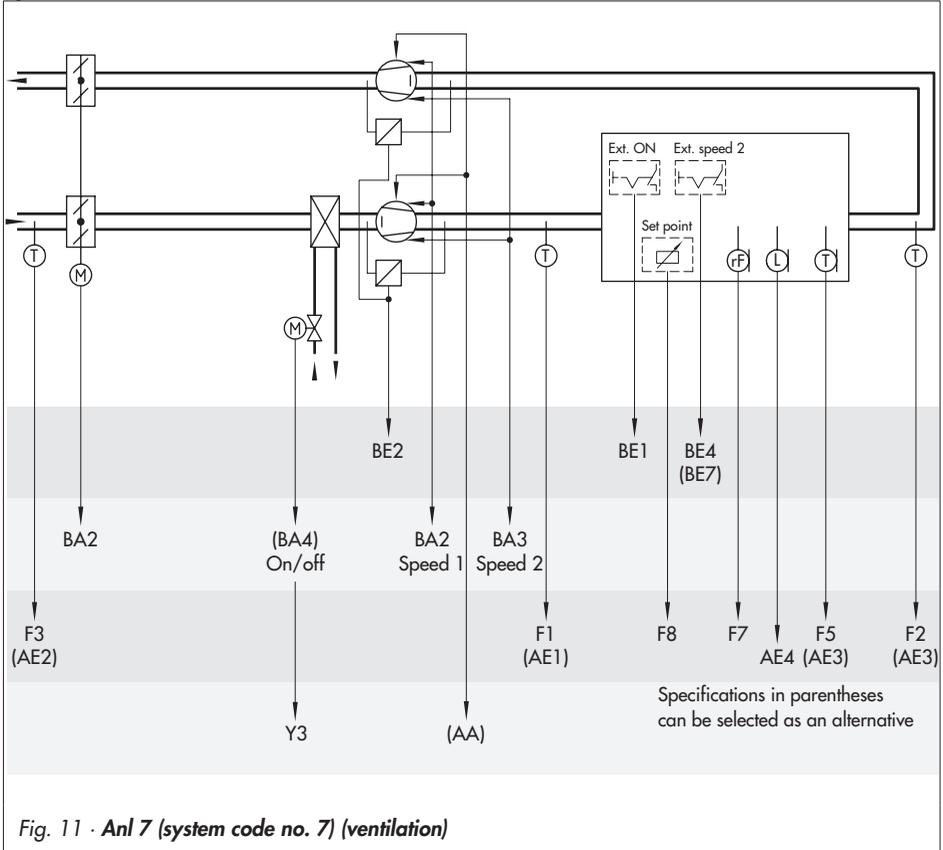
Fig. 11 · Anl 7 (system code no. 7) (ventilation)
