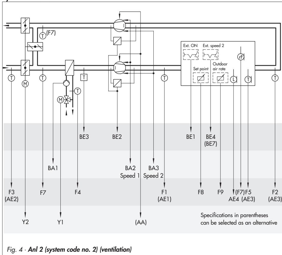
Fig. 4 · Anl 2 (system code no. 2) (ventilation)
