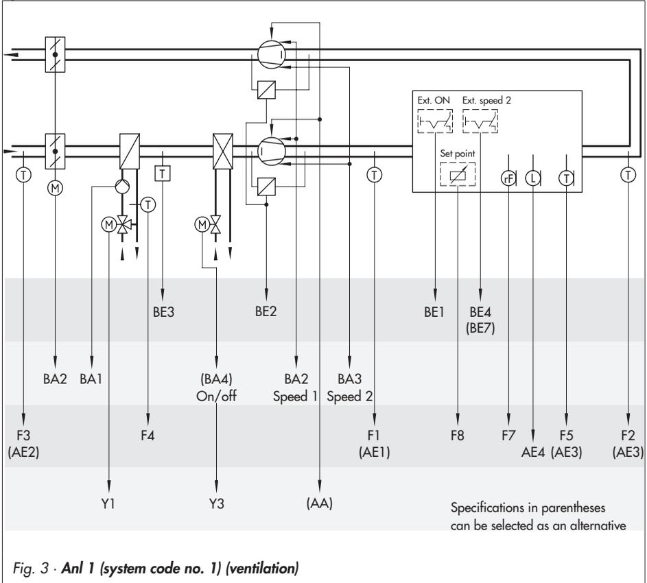
Fig. 3 · Anl 1 (system code no. 1) (ventilation)
