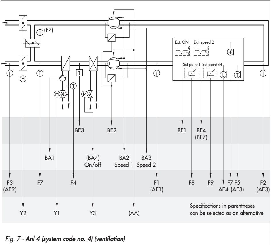
Fig. 7 · Anl 4 (system code no. 4) (ventilation)
