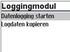
Der Anschluss des Datenlogging-Moduls erfolgt an der seitlichen RJ-45-Buchse. Nach erfolgtem Anschluss erscheint „Datenlogging starten“ und „Logdaten kopieren“ in der Anzeige des Reglers.
