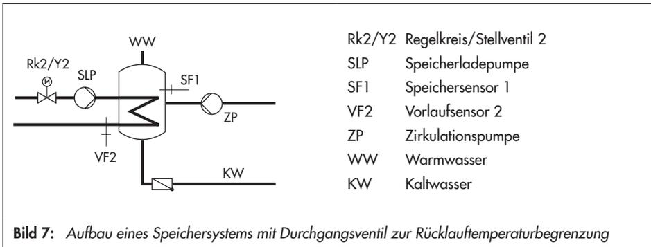
Durchgangventil und Temperatursensor VF2 dienen in der oben dargestellten Schaltungsvariante ausschließlich der Rücklauf Temperaturbegrenzung. Der Vorregelkreis stellt wie in der Standard-Schaltung mindestens eine Vorlauftemperatur zur Verfügung, die sich aus 'Sollwert Trinkwasser' + 'Überhöhung Ladetemperatur' + 'Überhöhung Sollwert Vorregelkreis' ergibt.
