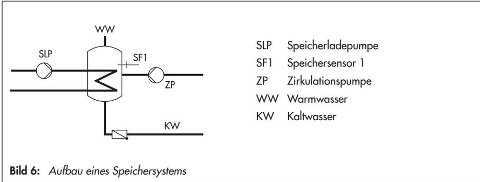
**Bild 6:** Aufbau eines Speichersystems
