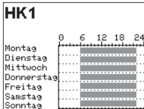
Drehschalter auf die Schalterstellung
