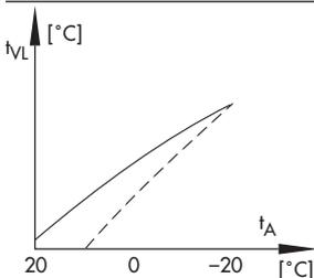
**Steigt die Raumtemperatur in der Übergangsjahreszeit**, ist eine Verringerung des Niveaus und gleichzeitige Erhöhung der Steigung erforderlich.
