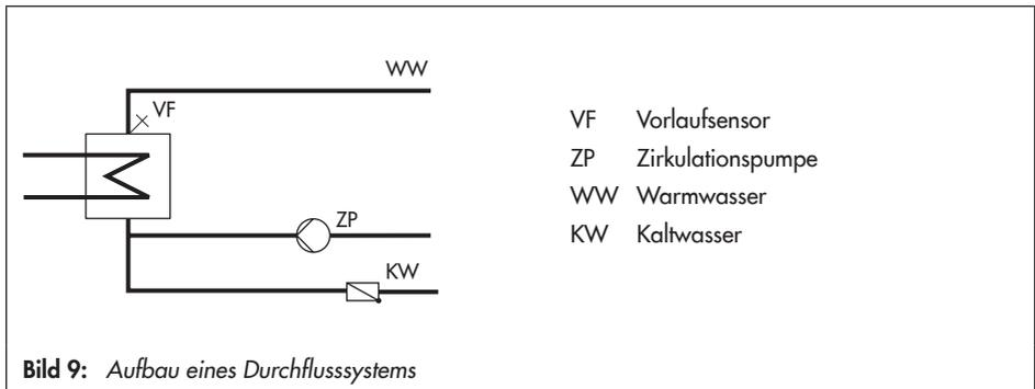
Die Regelung der gewünschten Trinkwassertemperatur am Vorlaufsensor VF ist nur während der Nutzungszeiträume der Zirkulationspumpe ZP aktiv.
