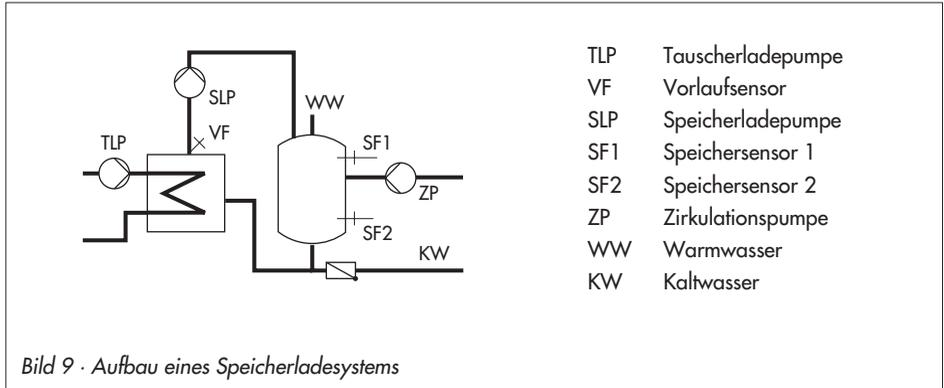
Der Regler startet die Speicherladung, wenn die am Sensor SF1 gemessene Wassertemperatur den Sollwert *Trinkwassertemperatur* um  $0,1\text{ °C}$  unterschreitet. Ist die Vorlauftemperatur in der Anlage höher als die gewünschte Ladetemperatur, versucht der Regler bis zu 3 Minuten lang, diese heizkreisseitig abzubauen, bevor die Tauscherladespumpe zusammen mit der Speicherladespumpe in Betrieb gesetzt wird.
