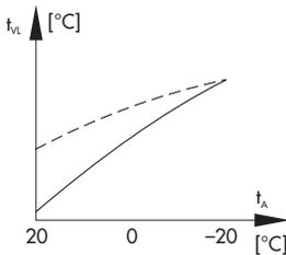
**Sinkt die Raumtemperatur in der Übergangsjahreszeit**, ist eine Erhöhung des Niveaus und gleichzeitige Verringerung der Steigung erforderlich.
