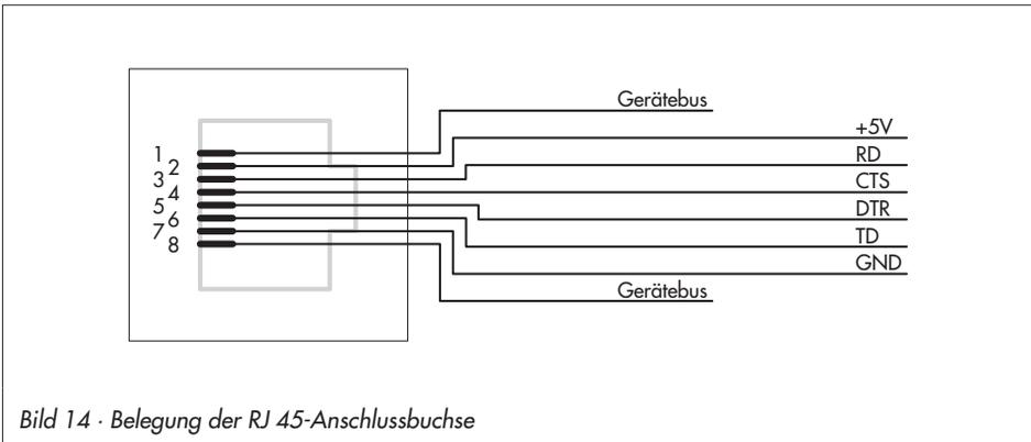
Bild 14 · Belegung der RJ 45-Anschlussbuchse
