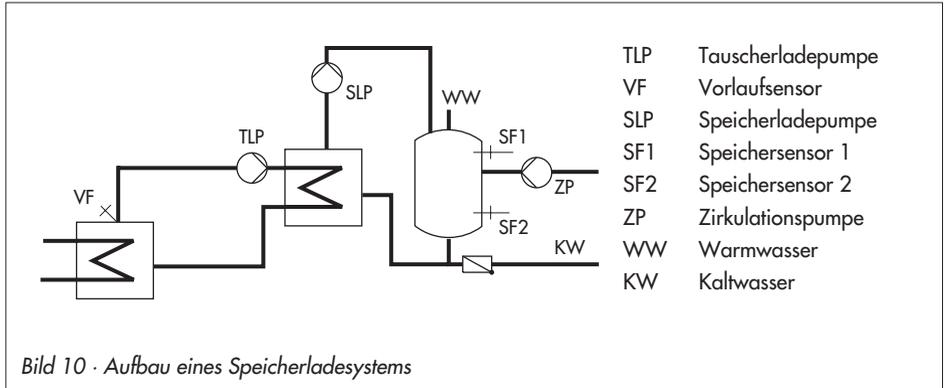
Der Regler startet die Speicherladung, wenn die am Sensor SF1 gemessene Wassertemperatur den *Sollwert Trinkwassertemperatur* um  $0,1\text{ °C}$  unterschreitet. Ist die Vorlauftemperatur in der Anlage höher als die gewünschte Ladetemperatur, versucht der Regler bis zu 3 Minuten lang, diese heizkreisseitig abzubauen, bevor die Tauscherladedpumpe zusammen mit der Speicherladedpumpe in Betrieb gesetzt wird.
