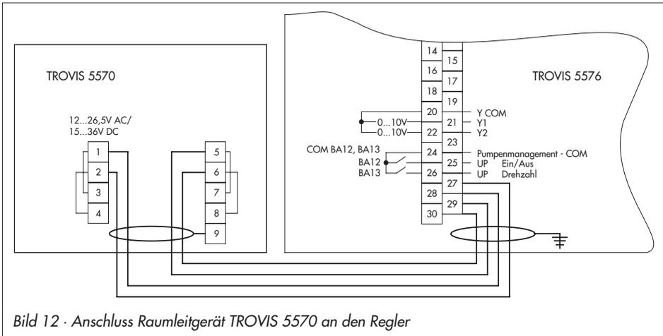
Bild 12 · Anschluss Raumleitgerät TROVIS 5570 an den Regler
