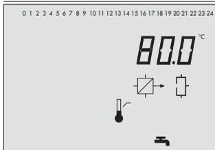
maximale Ladetemperatur (nur mit VF4)
