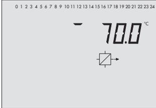
Temperatur am Vorlaufsensoren VF1, Primärtauscherkreis
