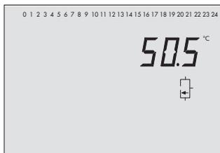
Temperatur am Speichersensoren SF2 (Trinkwasserspeicher)
