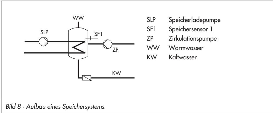
Bild 8 · Aufbau eines Speichersystems
