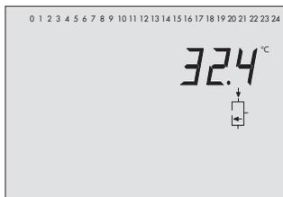
Temperatur am Speichersensoren SF3 (Trinkwasserspeicher)
