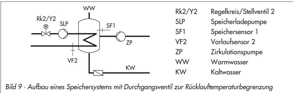
Durchgangsregelventil und Temperatursensor VF2 dienen in der oben dargestellten Schaltungsvariante ausschließlich der Rücklaufftemperaturbegrenzung. Der Vorregelkreis stellt wie in der Standardschaltung mindestens eine Vorlauftemperatur zur Verfügung, die sich aus *Sollwert Trinkwassertemperatur + Überhöhung Ladetemperatur + Überhöhung Sollwert Primärauscherregelung* ergibt.
