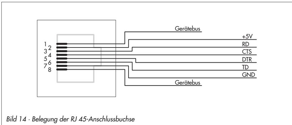
Bild 14 · Belegung der RJ 45-Anschlussbuchse
