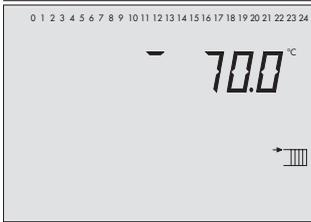
Temperatur am Vorlaufsensoren VF
