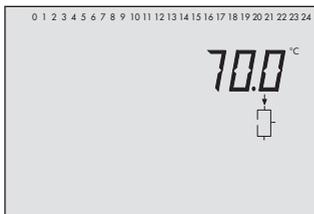
Temperatur am Solarkollektorsensor VF3
