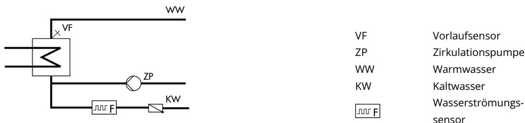
**Bild 20:** Aufbau eines Durchflusssystems
