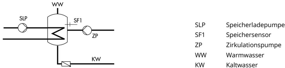
**Bild 17:** Aufbau eines Speichersystems
