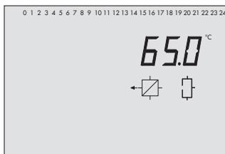
Temperatur am Rücklaufsensoren RÜF, Trinkwasserkreis
