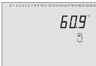
Temperatur am Speichersensoren SF1 (Trinkwasserspeicher)
