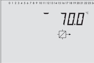
Temperatur am Vorlaufsensor VF1, Primärtauscherkreis
