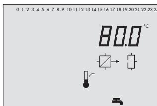
maximale Ladetemperatur (nur mit VF4)
