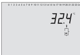
Temperatur am Speichersensoren SF3 (Trinkwasserspeicher)
