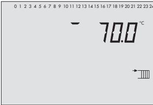
Temperatur am Vorlaufsensor VF
