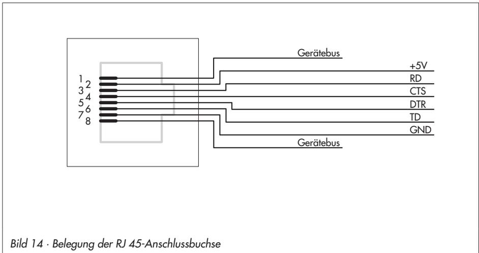
Bild 14 · Belegung der RJ 45-Anschlussbuchse
