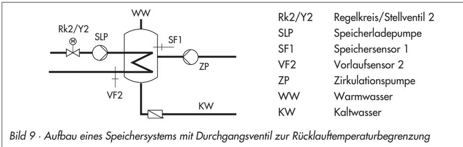
Durchgangsregelventil und Temperatursensor VF2 dienen in der oben dargestellten Schaltungsvariante ausschließlich der Rücklauftemperaturbegrenzung. Der Vorregelkreis stellt wie in der Standardschaltung mindestens eine Vorlauftemperatur zur Verfügung, die sich aus *Sollwert Trinkwassertemperatur + Überhöhung Ladetemperatur + Überhöhung Sollwert Primärtauscherregelung* ergibt.
