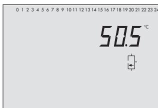
Temperatur am Speichersensoren SF2 (Trinkwasserspeicher)
