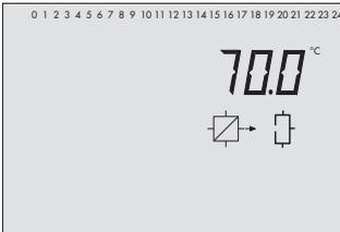
Temperatur am Vorlaufsensor VF2, Trinkwasserkreis
