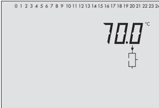
Temperatur am Solarkollektorsensor VF3
