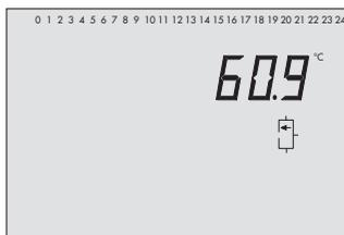
Temperatur am Speichersensoren SF1 (Trinkwasserspeicher)
