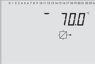
Temperatur am Vorlaufsensor VF1, Primärtauscherkreis
