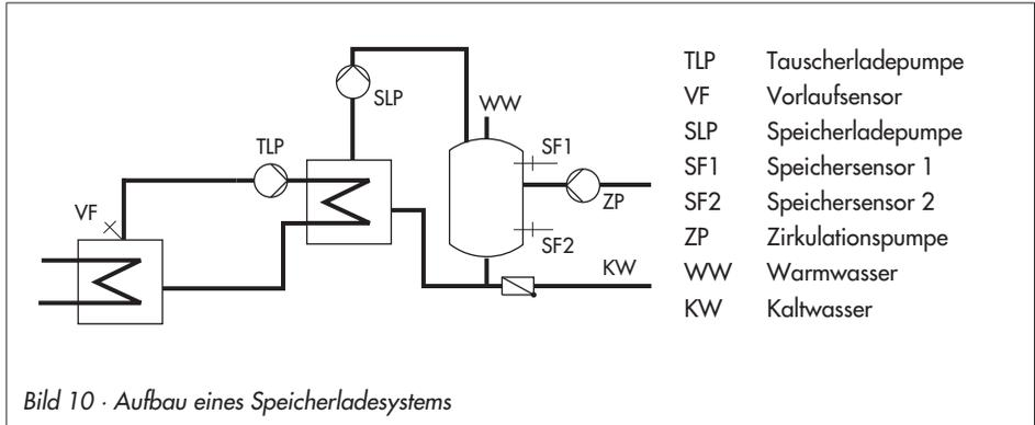
Der Regler startet die Speicherladung, wenn die am Sensor SF1 gemessene Wassertemperatur den *Sollwert Trinkwassertemperatur* um  $0,1\text{ °C}$  unterschreitet. Ist die Vorlauftemperatur in der Anlage höher als die gewünschte Ladetemperatur, versucht der Regler bis zu 3 Minuten lang, diese heizkreisseitig abzubauen, bevor die Tauscherladepumpe zusammen mit der Speicherladepumpe in Betrieb gesetzt wird.
