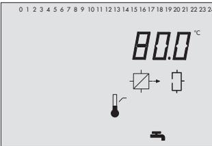
maximale Ladetemperatur (nur mit VF4)
