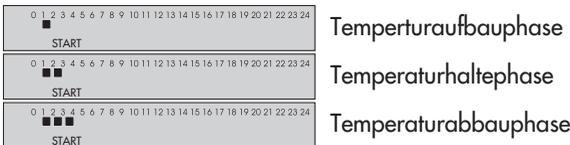
Erlischt die Zusatzanzeige im Bild der Vorlauftemperaturanzeige nach der letzten Phase, ist die Estrichrocknung vollständig abgelaufen. Jede Netzunterbrechung während des Verlaufs der Funktion führt zum automatischen Neubeginn der Estrichrocknung.
