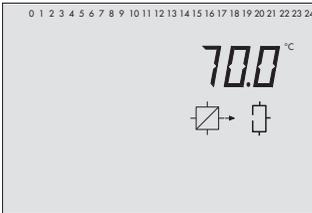
Temperatur am Vorlaufsensor VF2, Trinkwasserkreis
