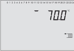
Temperatur am Vorlaufsensor VF
