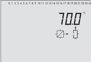
Temperatur am Vorlaufsensor VF4
