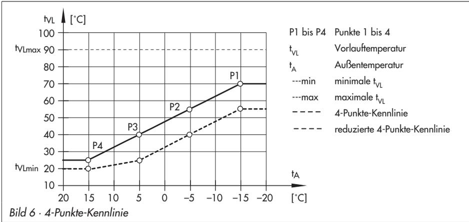
Mit Hilfe der 4-Punkte-Kennlinie kann eine eigene Heizkennlinie definiert werden. Die 4-Punkte-Kennlinie wird durch 4 Punkte für die Außentemperatur, die Vorlauftemperatur, die reduzierte Vorlauftemperatur und die Rücklauftemperatur definiert. Die Parameter maximale und minimale Vorlauftemperatur begrenzen die Vorlauftemperatur nach oben und unten.
