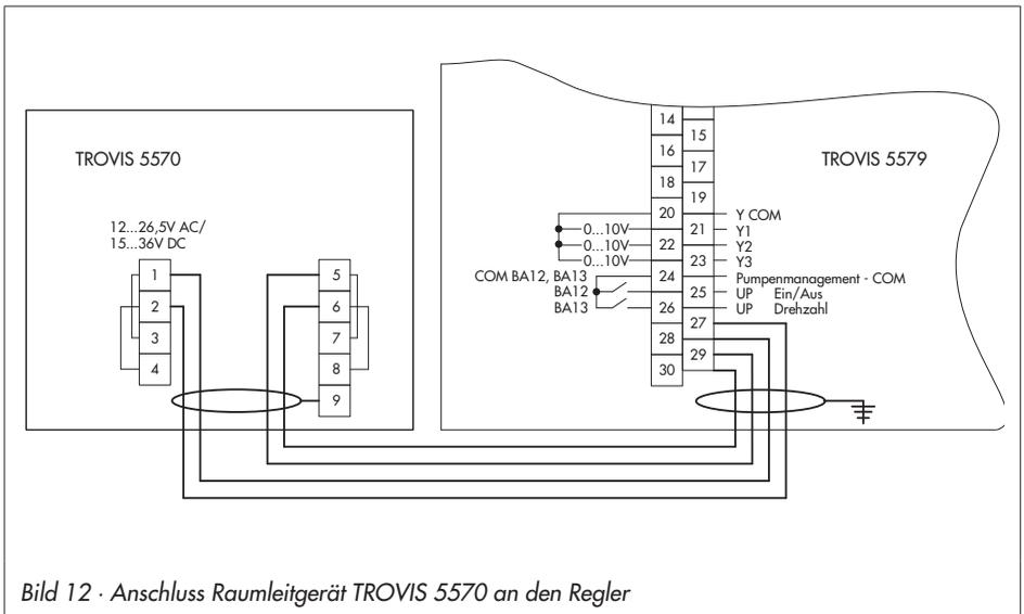
Bild 12 · Anschluss Raumleitgerät TROVIS 5570 an den Regler
