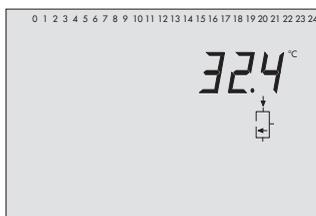
Temperatur am Speichersensoren SF3 (Trinkwasserspeicher)
