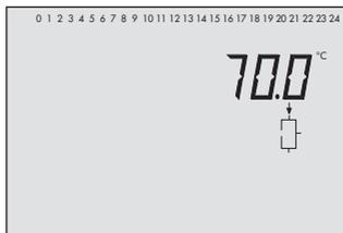
Temperatur am Solarkollektorsensoren VF3
