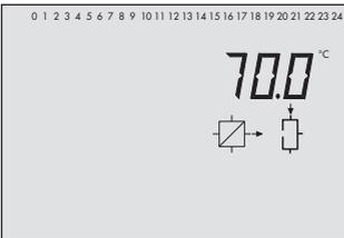
Temperatur am Vorlaufsensor VF4
