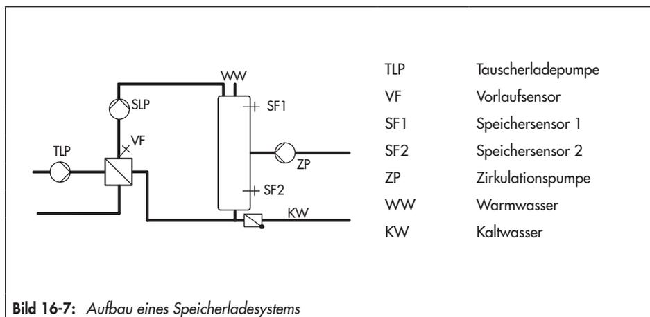
Wenn die am Sensor SF1 gemessene Wassertemperatur den 'Sollwert Trinkwassertemperatur' um 0,1 °C unterschreitet, startet der Regler die Speicherladung. Wenn die Vorlauftemperatur in der Anlage höher ist als die gewünschte Ladetemperatur, versucht der Regler bis zu drei Minuten lang, diese heizkreisseitig abzubauen, bevor die Tauscherladepumpe zusammen mit der Speicherladepumpe in Betrieb gesetzt wird.
