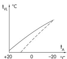
**Steigt die Raumtemperatur in der Übergangsjahreszeit**, ist eine Verringerung des Niveaus und die gleichzeitige Erhöhung der Steigung erforderlich.
