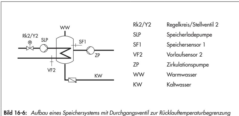
Durchgangsregelventil und Temperatursensor VF2 dienen in der oben dargestellten Schaltungsvariante ausschließlich der Rücklauf Temperaturbegrenzung. Der Vorregelkreis stellt wie in der Standardschaltung mindestens eine Vorlauf Temperatur zur Verfügung, die sich aus 'Sollwert Trinkwassertemperatur' + 'Überhöhung Ladetemperatur' + 'Überhöhung Sollwert Primärauscherregelung' ergibt.
