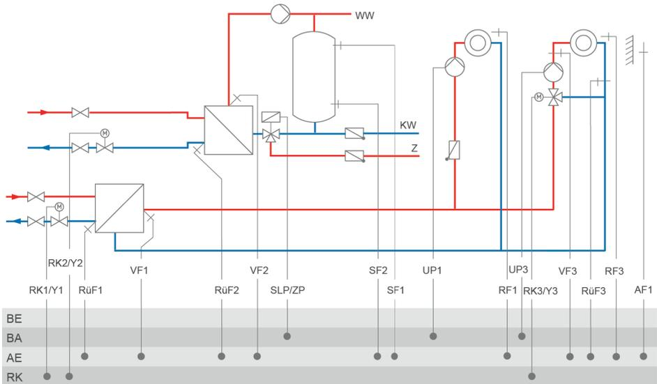
RK3: CO3 -> F02 - 0 = Festwertregelung; CO3 -> F02 - 1, Auswahl AF1 = witterungsgeführte Regelung mit AF1; CO3 -> F02 - 1, Auswahl AF2 = witterungsgeführte Regelung mit AF2
