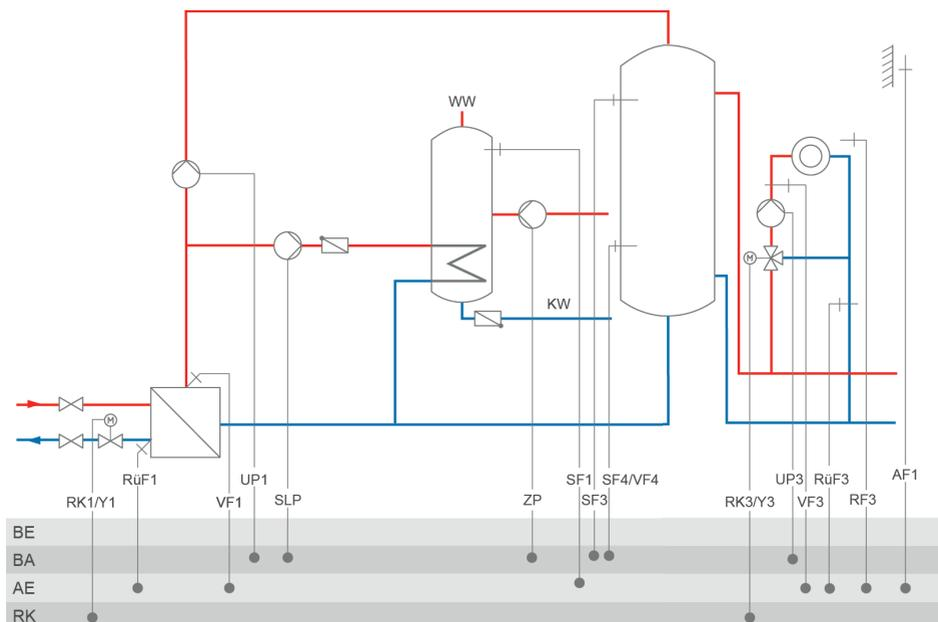
RK3: CO3 -> F02 - 0 = Festwertregelung; CO3 -> F02 - 1, Auswahl AF1 = witterungsgeführte Regelung mit AF1; CO3 -> F02 - 1, Auswahl AF2 = witterungsgeführte Regelung mit AF2
