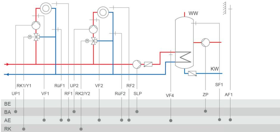
RK2: CO2 -> F02 - 0 = Festwertregelung; CO2 -> F02 - 1, Auswahl AF1 = witterungsgeführte Regelung mit AF1; CO2 -> F02 - 1, Auswahl AF2 = witterungsgeführte Regelung mit AF2
