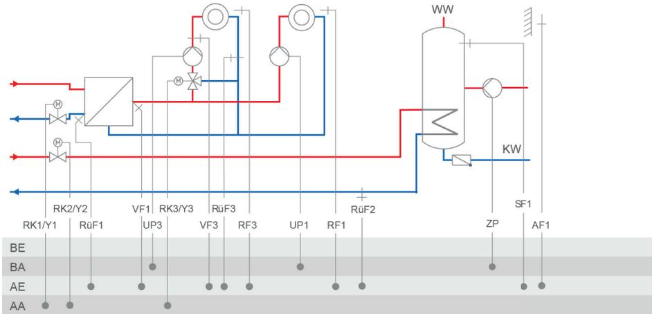
RK3: CO3 -> F02 - 0 = Festwertregelung; CO3 -> F02 - 1, Auswahl AF1 = witterungsgeführte Regelung mit AF1; CO3 -> F02 - 1, Auswahl AF2 = witterungsgeführte Regelung mit AF2
