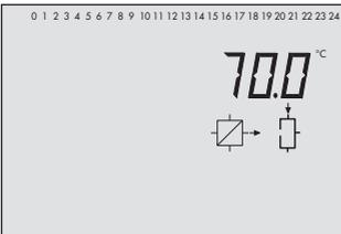
Temperatur am Vorlaufsensor VF4
