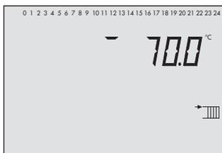
Temperatur am Vorlaufsensoren VF
