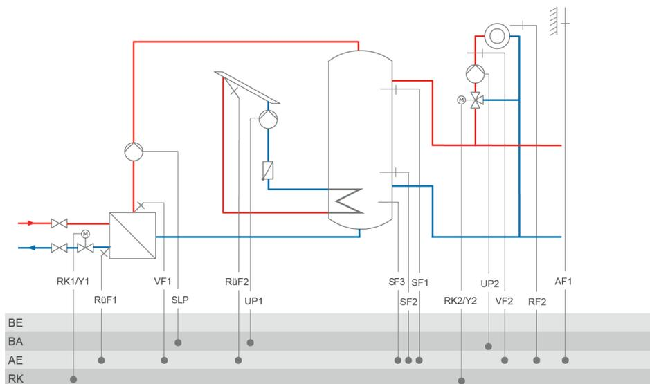
RK2: CO2 -> F02 - 0 = Festwertregelung; CO2 -> F02 - 1, Auswahl AF1 = witterungsgeführte Regelung mit AF1; CO2 -> F02 - 1, Auswahl AF2 = witterungsgeführte Regelung mit AF2
