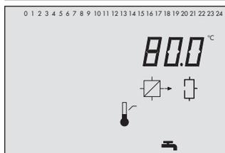
Maximale Ladetemperatur (nur mit VF4)
