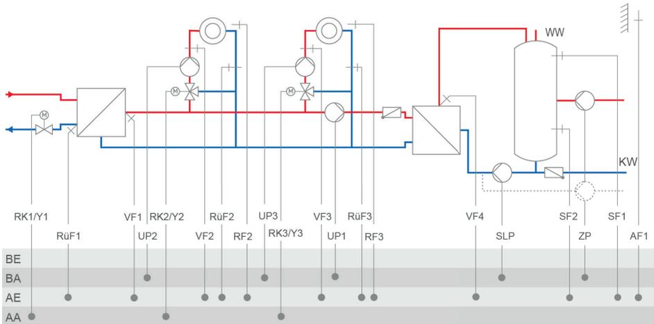
RK2: CO2 -> F02 - 0 = Festwertregelung; CO2 -> F02 - 1, Auswahl AF1 = witterungsgeführte Regelung mit AF1; CO2 -> F02 - 1, Auswahl AF2 = witterungsgeführte Regelung mit AF2
