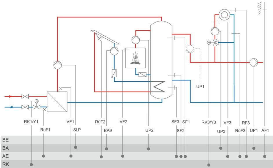
RK3: CO3 -> F02 - 0 = Festwertregelung; CO3 -> F02 - 1, Auswahl AF1 = witterungsgeführte Regelung mit AF1; CO3 -> F02 - 1, Auswahl AF2 = witterungsgeführte Regelung mit AF2
