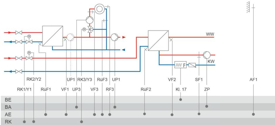
RK3: CO3 -> F02 - 0 = Festwertregelung; CO3 -> F02 - 1, Auswahl AF1 = witterungsgeführte Regelung mit AF1; CO3 -> F02 - 1, Auswahl AF2 = witterungsgeführte Regelung mit AF2
