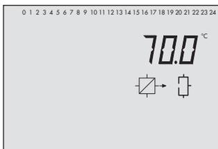
Temperatur am Vorlaufsensoren VF2,
