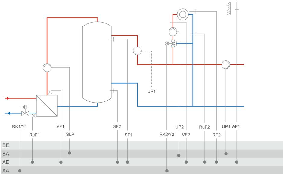
RK2: CO2 -> F02 - 0 = Festwertregelung; CO2 -> F02 - 1, Auswahl AF1 = witterungsgeführte Regelung mit AF1; CO2 -> F02 - 1, Auswahl AF2 = witterungsgeführte Regelung mit AF2
