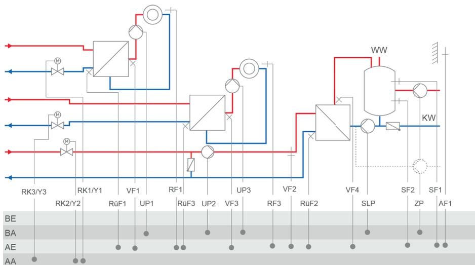
RK3: CO3 -> F02 - 0 = Festwertregelung; CO3 -> F02 - 1, Auswahl AF1 = witterungsgeführte Regelung mit AF1; CO3 -> F02 - 1, Auswahl AF2 = witterungsgeführte Regelung mit AF2
