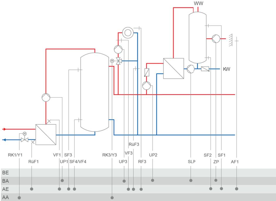
RK3: CO3 -> F02 - 0 = Festwertregelung; CO3 -> F02 - 1, Auswahl AF1 = witterungsgeführte Regelung mit AF1; CO3 -> F02 - 1, Auswahl AF2 = witterungsgeführte Regelung mit AF2
