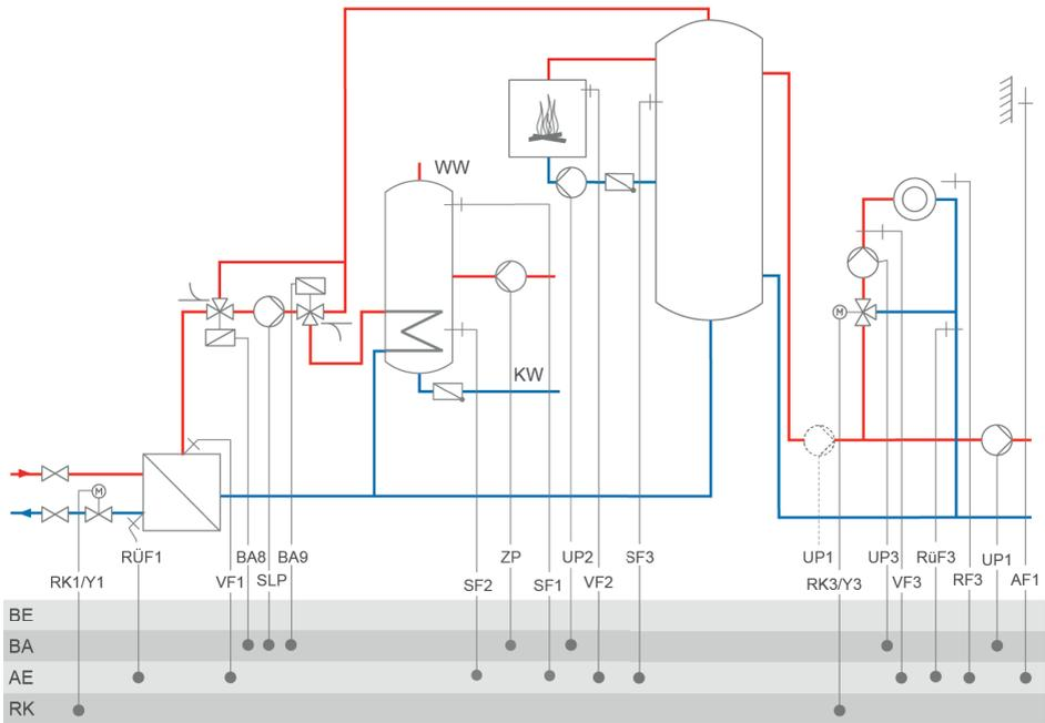
RK3: CO3 -> F02 - 0 = Festwertregelung; CO3 -> F02 - 1, Auswahl AF1 = witterungsgeführte Regelung mit AF1; CO3 -> F02 - 1, Auswahl AF2 = witterungsgeführte Regelung mit AF2
