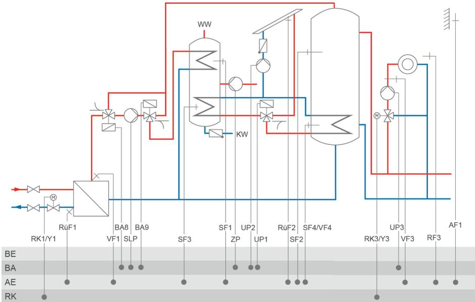
RK3: CO3 -> F02 - 0 = Festwertregelung; CO3 -> F02 - 1, Auswahl AF1 = witterungsgeführte Regelung mit AF1; CO3 -> F02 - 1, Auswahl AF2 = witterungsgeführte Regelung mit AF2
