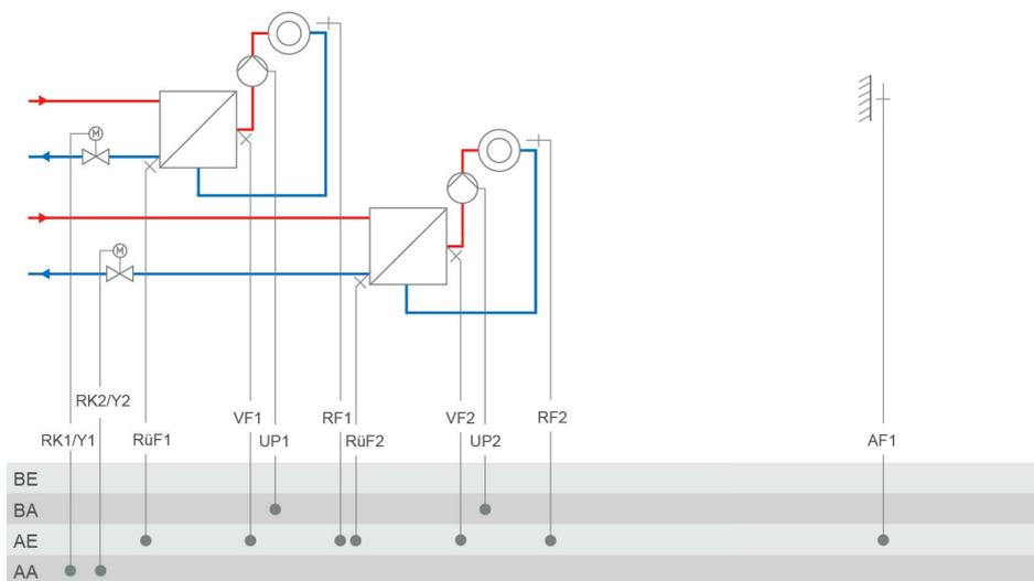
RK2: CO2 -> F02 - 0 = Festwertregelung; CO2 -> F02 - 1, Auswahl AF1 = witterungsgeführte Regelung mit AF1; CO2 -> F02 - 1, Auswahl AF2 = witterungsgeführte Regelung mit AF2
