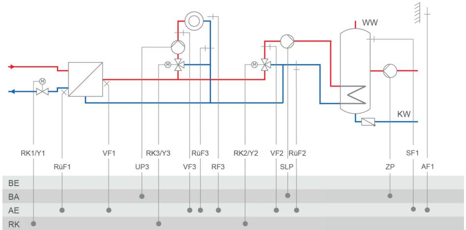
RK3: CO3 -> F02 - 0 = Festwertregelung; CO3 -> F02 - 1, Auswahl AF1 = witterungsgeführte Regelung mit AF1; CO3 -> F02 - 1, Auswahl AF2 = witterungsgeführte Regelung mit AF2
