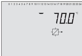
Temperatur am Vorlaufsensoren VF1,
