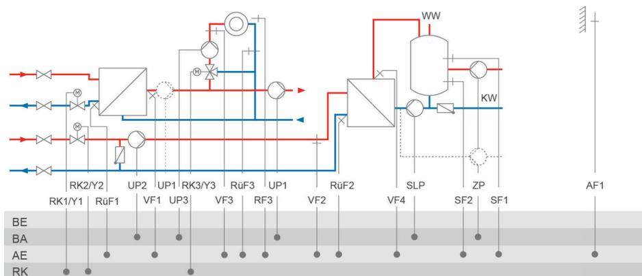
RK3: CO3 -> F02 - 0 = Festwertregelung; CO3 -> F02 - 1, Auswahl AF1 = witterungsgeführte Regelung mit AF1; CO3 -> F02 - 1, Auswahl AF2 = witterungsgeführte Regelung mit AF2
