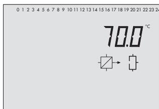
Température à la sonde de départ VF2, Boucle ECS
