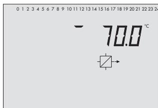
Température à la sonde de départ VF1, boucle d'échangeur primaire
