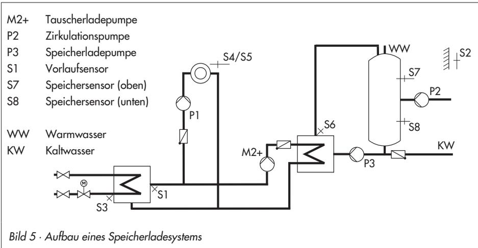
Der Regler startet die Speicherladung, wenn die am Speichersensor S7 gemessene Wassertemperatur den 'TWW-Sollwert Tag' um 0,1 °C unterschreitet. Ist die Vorlauftemperatur in der Anlage höher als die gewünschte Ladetemperatur (= 'TWW-Sollwert Tag' + 'Überhöhung Ladetemperatur'), versucht der Regler bis zu fünf Minuten lang, diese heizkreisseitig abzubauen, bevor die Tauscherladepumpe M2+ zusammen mit der Speicherladepumpe P3 in Betrieb gesetzt wird.
