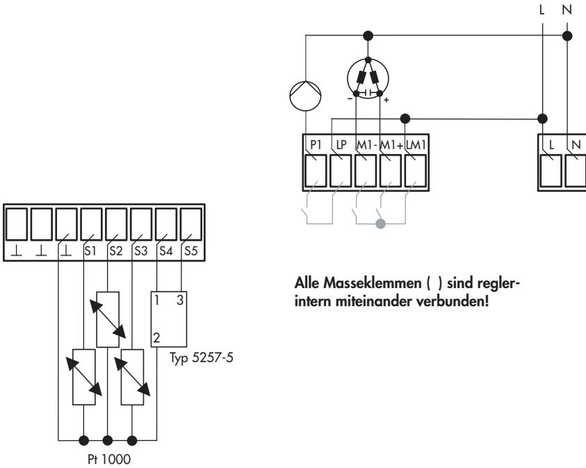
Bild 10 · Elektrischer Anschluss – Ausführung Kompakt (Ansicht auf Reglerrückseite)
