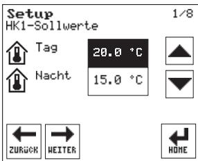
Bei Anlagen mit Raumsensor wird die Raumtemperatur des Referenzraumes – hier befindet sich der Raumsensor – mit absolutem Wert vorgegeben.
