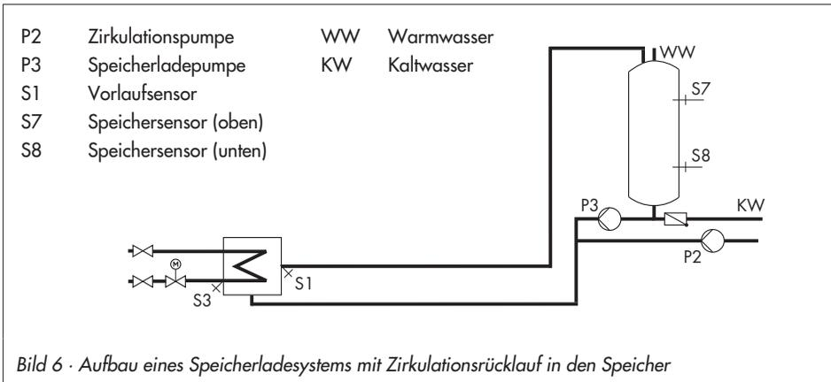
Bei aktiver Funktion **Zirkulationsrücklauf in Tauscher** bleibt die Regelung des 'TWW-Sollwertes Tag' in Abhängigkeit des Zeitprogramms aktiv, auch dann, wenn die Temperatur  $T = \text{'TWW-Sollwert Tag'} + \text{'Schaltdifferenz'}$  am Speichersensor S8 überschritten wurde. Auf diese Weise werden Zirkulationsverluste, auch bei kleineren Zapfmengen, über den Wärmetauscher kompensiert.
