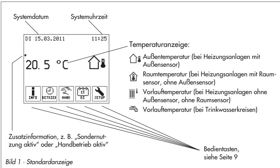
Über die Bedientasten der Standardanzeige können die verschiedenen Regler-Dialoge zur Bedienung und Inbetriebnahme angewählt werden:
