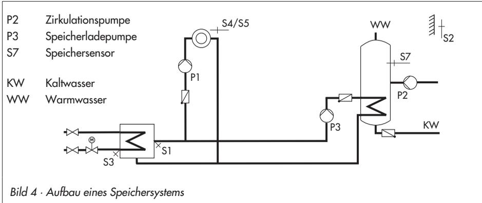
Der Regler startet die Speicherladung, wenn die am Speichersensor S7 gemessene Wassertemperatur den 'TWW-Sollwert Tag' um 0,1 °C unterschreitet. Findet kein Heizbetrieb statt, dann wird die Speicherladepumpe P3 unverzüglich eingeschaltet.
