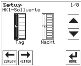
Bei Anlagen ohne Raumsensor ist die genaue Raumtemperatur nicht bekannt. Die Sollwerte werden in vier Stufen mit je 2 K erhöht oder verringert.
