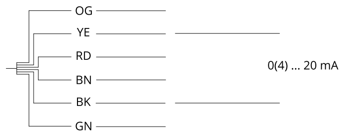
Bild 16: Elektrischer Anschluss · Stromeingang für Sollwert oder Istwert
