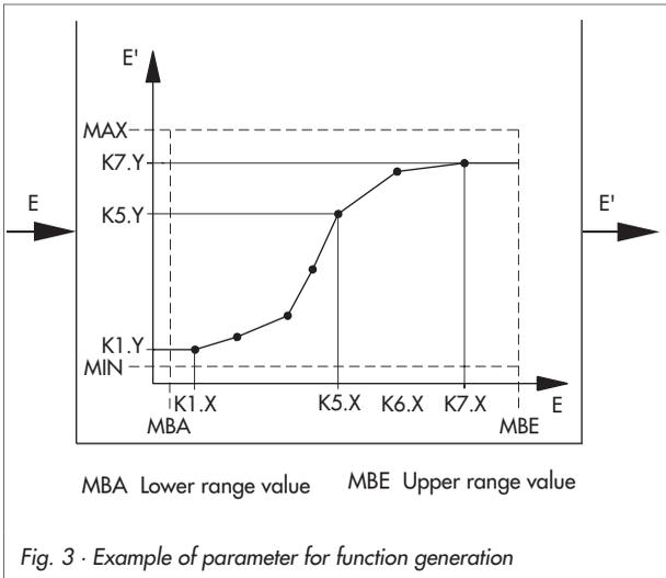
Fig. 3 · Example of parameter for function generation
