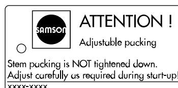
Рис. 3: Шильдик регулируемого сальникового уплотнения
