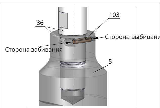
Рис. 36: Стопорный штифт между плунжером и штоком плунжера или поршнем и штоком поршня (принципиальная схема)
