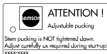
Kuva 3: Etiketti, jos asennettuna on säädettävä tiivistesarja
