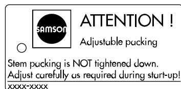
Fig. 3: Etikett när en justerbar packning har installerats
