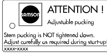
Fig. 3: Ayarlanabilir sızdırmazlık grubu olduğunda etiket
