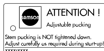
Рис. 4: Шильдик регулируемого сальникового уплотнения
