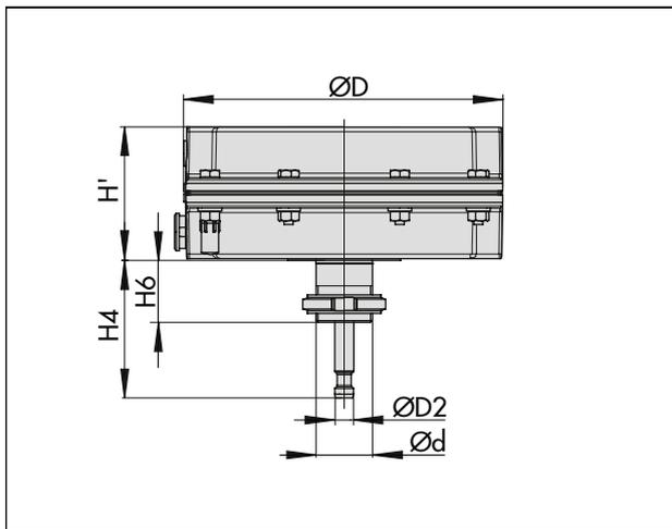
**Fig. 7:** Type 3271-5 · 120 cm<sup>2</sup> actuator area
