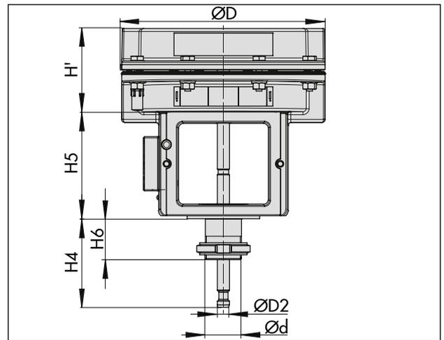
**Fig. 9:** Type 3277-5 · 120 cm<sup>2</sup> actuator area
