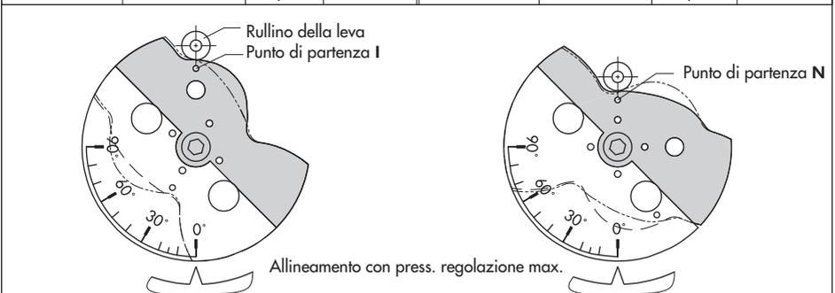
Figura 9 · Taratura del disco a camma per attuatore rotativo a semplice effetto
