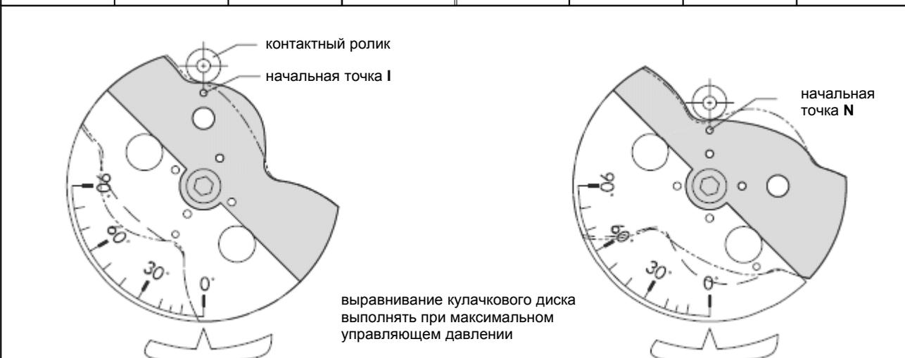
Рис.9 • Установка кулачкового диска
