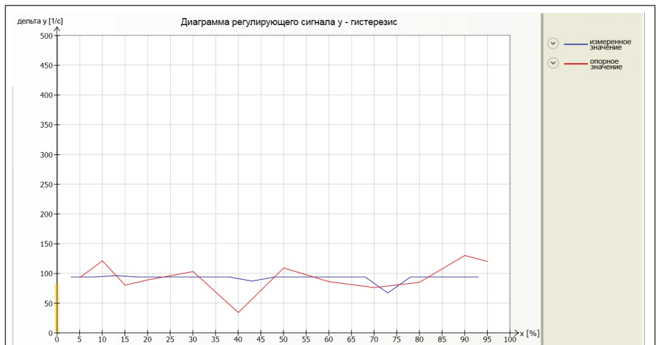
Рис. 7: Диагностика > Статистическая информация > Диаграмма регулирующего сигнала у – гистерезис
