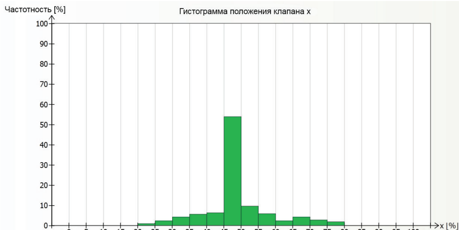
Рис. 3: Диагностика > Статистическая информация > Гистограмма положения клапана x
