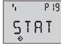
**P19:** моделирование контакта сигнализации неисправностей
