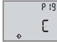
**P19:** моделирование контакта С (сигнал о достижении целевого диапазона PST при проведении теста частичного хода)
