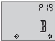
**P19:** моделирование контакта В (конечный выключатель - рабочее положение)
