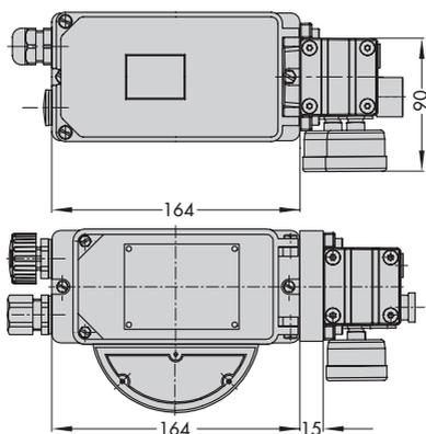
Montaje del amplificador inversor con placa de conexiones (núm. de referencia 1400-9621, 15 mm) en posicionador Tipo 3766/3767 o Tipo 3780 (con índice inferior a .05)
