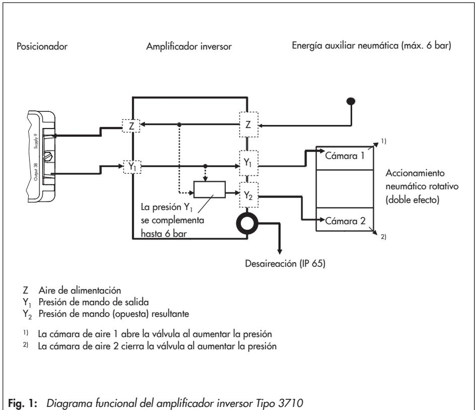
Fig. 1: Diagrama funcional del amplificador inversor Tipo 3710
