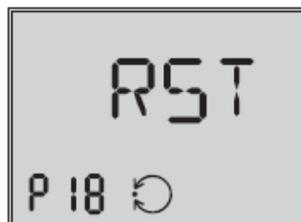
После того, как произойдет перегрузка установок на приборе, дисплей автоматически вернется к индикации статуса (P0). На дисплее отображается угол в градусах по отношению к продольной оси.
