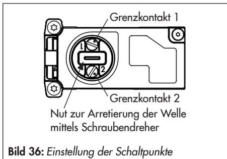
**Bild 36:** Einstellung der Schaltpunkte
