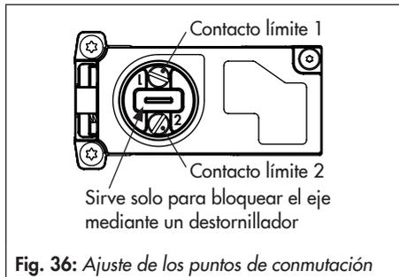
Fig. 36: Ajuste de los puntos de conmutación
