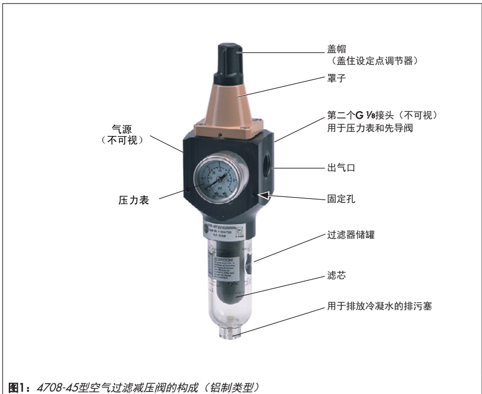
图1：4708-45型空气过滤减压阀的构成（铝制类型）
