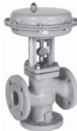
Háromjáratú szelep Típus 3244-1, 3271 típusú pneumatikus állítóművel
