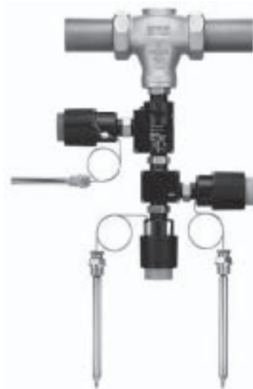
Kombináció: állító-szelep Típus 2432 K, 2439 K típusú biztonsági hőmérséklet-határolóval és Do3K kettős csatlakozással, két 2430 K típusú termosztáttal
