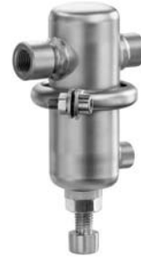
Van giảm áp Loại M 44-2 Nối kết G 1/4, Kvs = 0.15
