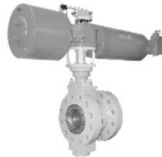
Van bướm cao áp Leusch Loại LTR 43 với thân mặt bích kép 10", cấp ANSI 1500 với cơ cấu dẫn động khí nén và bộ định vị
