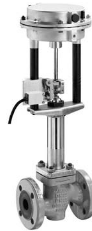
Van hình cầu V 2001-P cho dầu truyền nhiệt với cơ cấu dẫn động khí nén và chuyển mạch giới hạn bằng điện loại 4744-2
