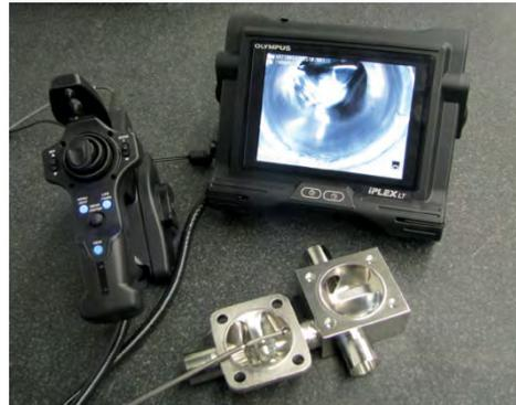
内窥镜检测卫生级隔膜阀的内表面及焊缝
