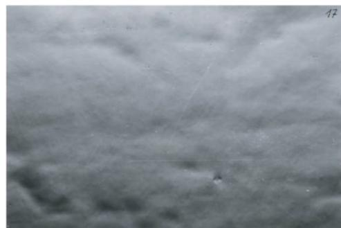
下图在显微镜下，经过机械抛光和电解抛光后阀体内表面的情况，内表面光洁度为 Ra 0,25  $\mu\text{m}$  / 10  $\mu$ -英寸
