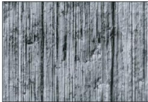
下图在显微镜观察下，经过砂粒 400 机械抛光后阀体内表面的情况，内表面光洁度为 Ra 0,25  $\mu\text{m}$  / 10  $\mu$ -英寸
