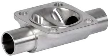
锻造后的阀体，致密性高，结构均匀，无砂眼、气孔或其他杂质。根据技术规范的要求，再对锻造后的阀体进行机加工，生产出相应的成品阀体。
