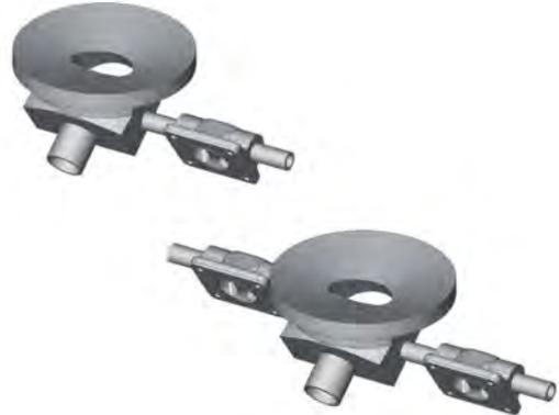
对于左面所有结构，焊接阀门全部旋转到自排空位置，并延长到消除对罐底的影响。
