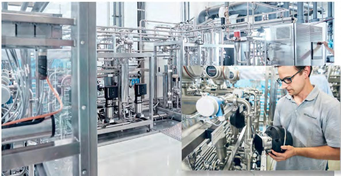
工艺试验台。使用自动化饱和蒸汽和各种定位清洗介质对隔膜和阀门进行循环和寿命测试。
