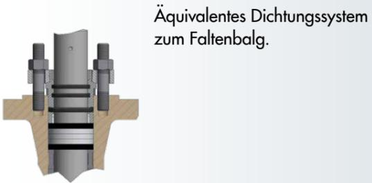
Äquivalentes Dichtungssystem zum Faltenbalg.
