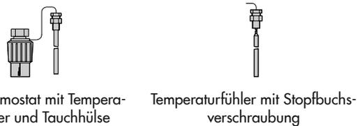
Bild 1: Regelthermostat mit den verschiedenen Fühlerausführungen
