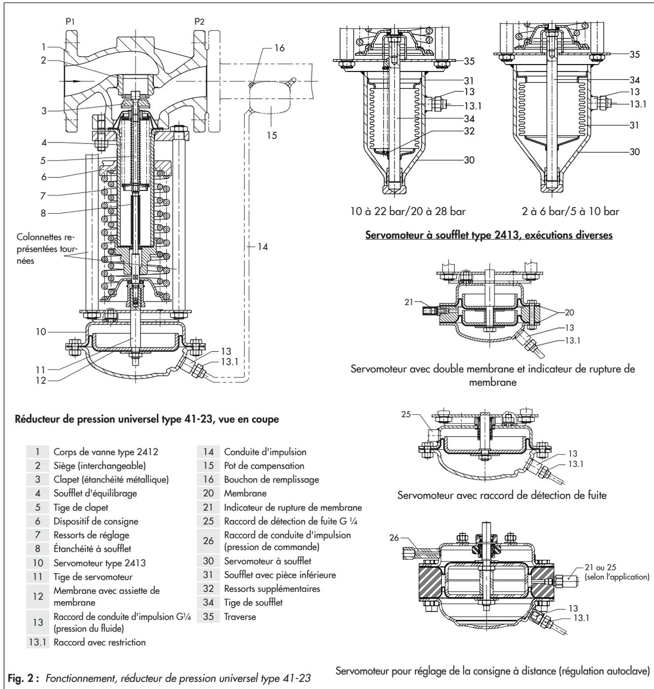
Fig. 2 : Fonctionnement, réducteur de pression universel type 41-23
