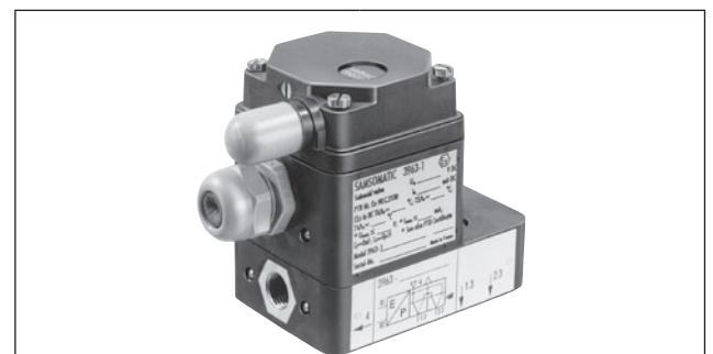
Fig. 1: Electroválvula 5/2-vías · Accionamiento simple Con resorte de retorno · Valor K_{VS} 0,16 · Conexión G 1/4
