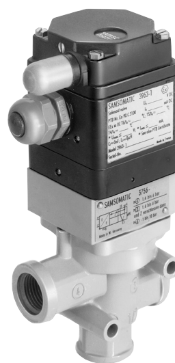
図. 2: 3/2 方向ソレノイドバルブ・シングルソレノイド形・スプリングリターン機構付き・ K_{VS} 4.3 ・G 1/2 接続
