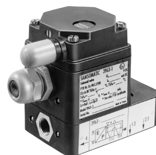
図. 1: 5/2 方向ソレノイドバルブ・シングルソレノイド形・スプリングリターン機構付き・ K_{VS} 0.16 ・G 1/4 接続
