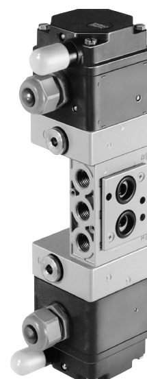
図. 3: 5/2 方向ソレノイドバルブ・ダブルソレノイド形・2つの戻り止め付き・ K_{VS} 1.4 ・G 1/4 接続、NAMUR
