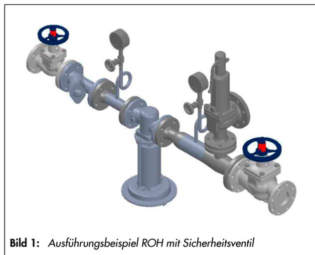
**Bild 1:** Ausführungsbeispiel ROH mit Sicherheitsventil
