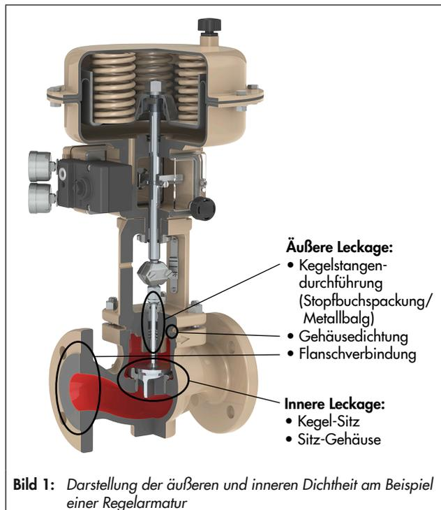
Die Maßnahmen zur Minderung der äußeren Leckage lassen sich in statische und dynamische Dichtstellen einteilen. Zu den statischen Dichtstellen zählen Gehäusedichtungen und Flanschverbindungen. Die dynamischen Dichtstellen sind die Stopfbuchspackung, der Faltenbalg und die Membranabdichtung.
