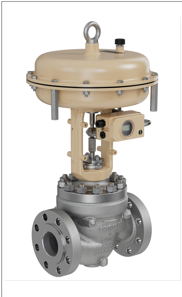
Kuva 1: SMS MG-1: tyyppi 251GR istukkaventtiili jossa tyyppi 3271 pneumaattinen toimilaite
