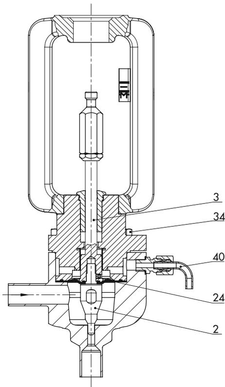
**Bild 2:** Eckventil Typ 3349 · Ausführung mit Abstreifer und Prüfanschluss
