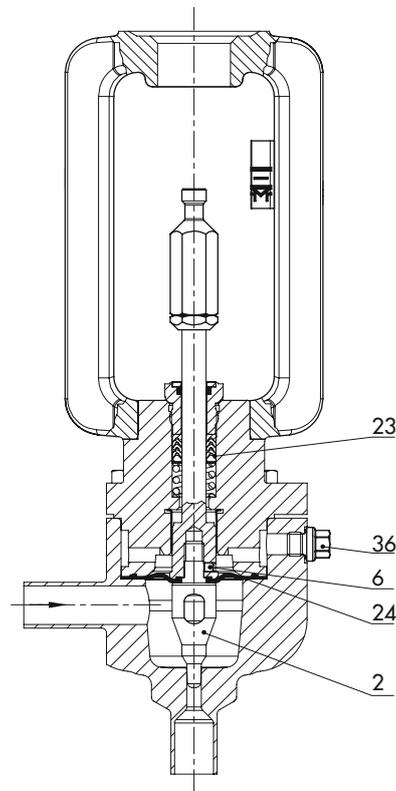
**Bild 3:** Eckventil Typ 3349 · Ausführung mit zusätzlicher Stopfbuchspackung
