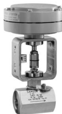
Fig. 3 · Reguleringventil Type 3510-1 med aktuator Type 3271-52 med 60 cm 2 membranareal
