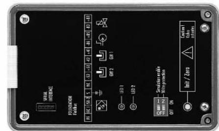
Fig. 17 · Interior del posicionador tipo 3787
